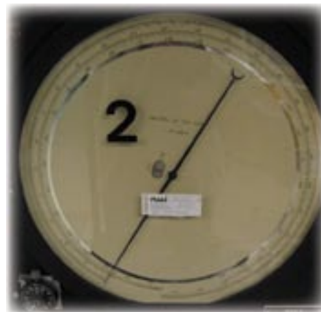
Teksten 'metres of sea water' er typisk på manometer for metningsdykking
