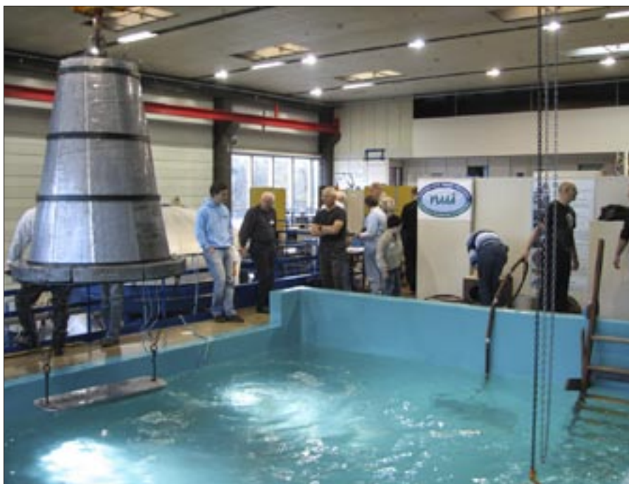
Utstyr fra tre generasjoner i bassenget samtidig - åpen klokke, hjelmdykking med sveivepumpe og moderne marinedykking. Foto: Eirik Myrseth
