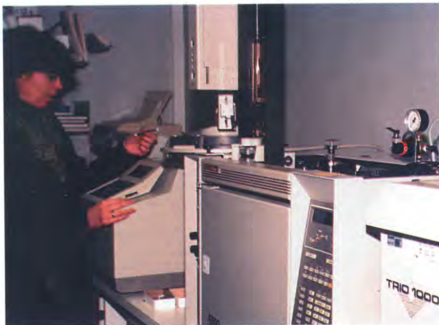
Cand. scient. Tone Bjørlykke i ferd med å analysere Tenaxprøver på gaskromatograf/massespektrometer.
