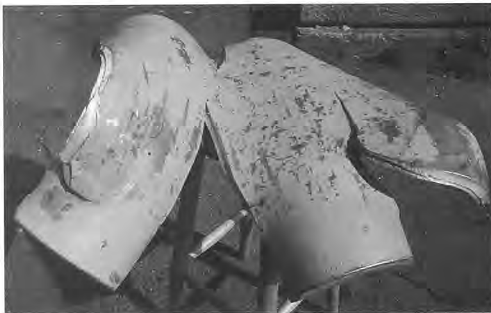
Dette er den flaske som eksploderte i en garasje på Tjøme. Intet, verken utvendig eller innvendig, ville ha røpet at dette var en "udetonert bombe" etter fylling.
