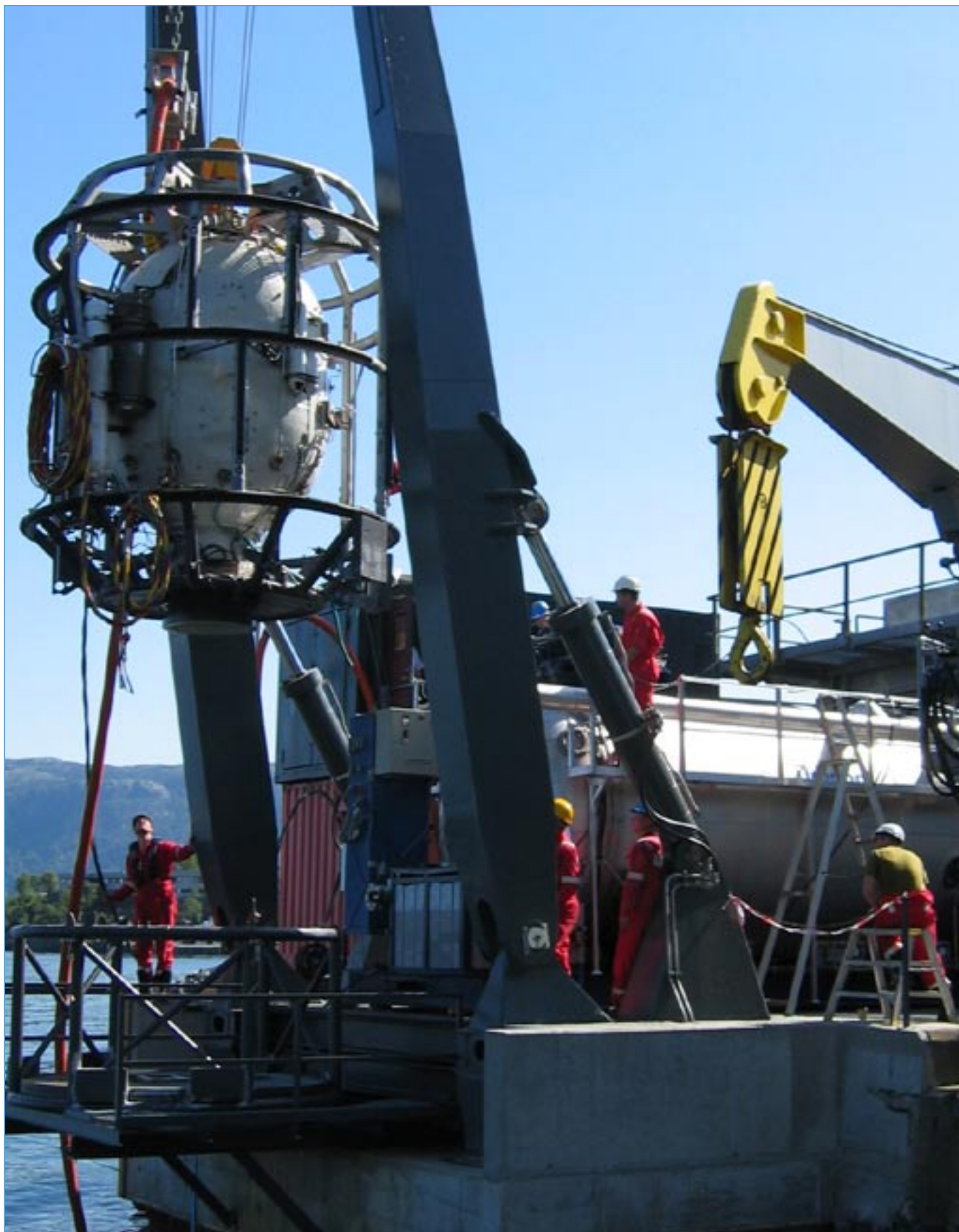
Beredskapskammeret på NUI som skal brukes ved evakuering fra DSV med hyperbar livbåt er tatt i bruk til opplæring av metningsdykkere. Det skal gi gode synergier i fremtiden mellom HiB og NUIs aktiviteter.
