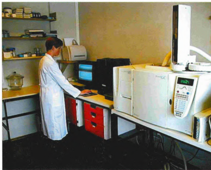
NUI Analyselaboratorium med ATD 400 (termisk desorpsjon) og nye Trace gasskromatograf og massespektrometer (GC-MS). (Foto: Alf Schønhardt)
