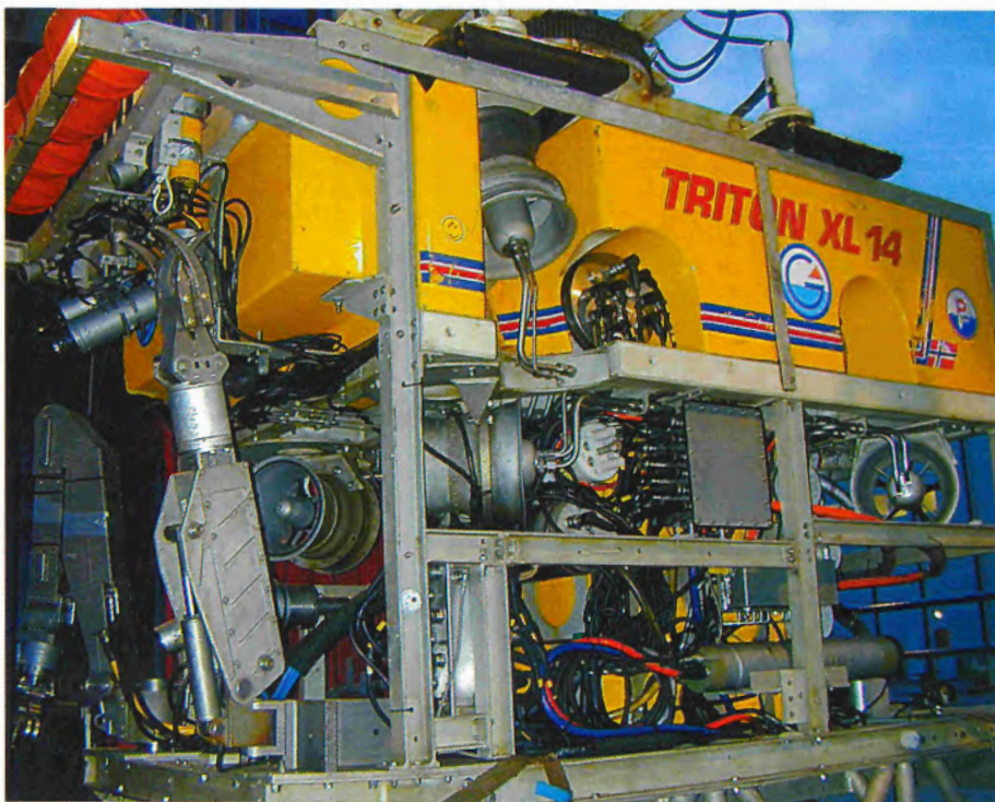
En arbeids-ROV eller såkalt WROV. (Foto: Yngve Bergflødt)
